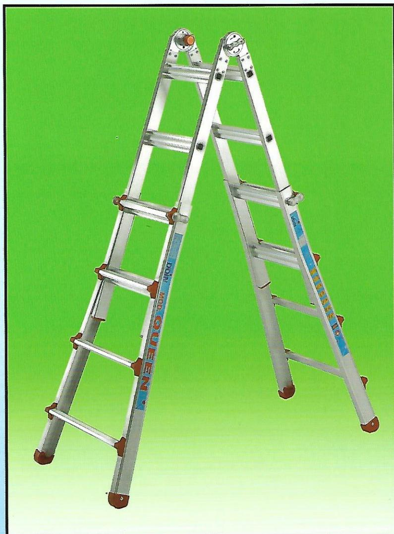
La scala **QUEEN** è costruita in alluminio e rispetta le più rigorose norme di sicurezza, attraverso sistemi semplici ed elevata resistenza a partire dalla **CERNIERA IN ACCIAIO ZINCATO** e dal **BLOCCA GRADINO** in alluminio. Quest'ultimo a sezione quadrata, elimina il maggior numero di laschi fra i montanti di alluminio.
